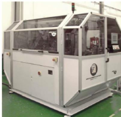
Процесс нагрева преформ и выдува осуществляется внутри кабины, которая состоит из стенок из алюминия и комбинированных панелей из матового материала и стекла. Здесь операторы защищены от потенциально опасных материалов.
